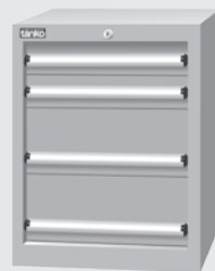
EHA-7041 標準型工具櫃 工具櫃尺寸： H725 x W566 x D607 抽屜荷重50kg 詳見P75 抽屜配件： 第一層配置分類盒， 其他層配置隔板二支
